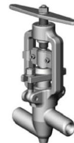
Клапаны регулирующие DN 10, 20 и 65 серий 584, 597, 1031, 1032, 976 применяются в качестве регуляторов расхода воды и дросселирования пара и устанавливаются на вспомогательных трубопроводах воды и пара высоких и сверхкритических параметров. Материал корпуса — сталь 25, 20 для воды и сталь 12Х1МФ.
