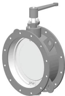
Затворы поворотные дисковые серии 12с-1 предназначены для регулирования расхода пара при перепаде давления не более 0,25 МПа. Регулирование затворов серии 12с-1 осуществляется за счет изменения площади проходного сечения между корпусом и дроссельной заслонкой при ее повороте. Полное открытие затворов соответствует повороту рычага на угол 75° от закрытого положения. Присоединение к трубопроводу - под сварку. В качестве запорных органов затворы не применяются.
